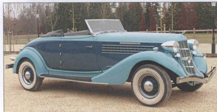
Слева Оберн-851 с кузовом типа купе-кабриолет со складывающимся тентом. Справа – Оберн-851 с двухместным спортивным кузовом спидстер, прозванным «рыбий хвост»
