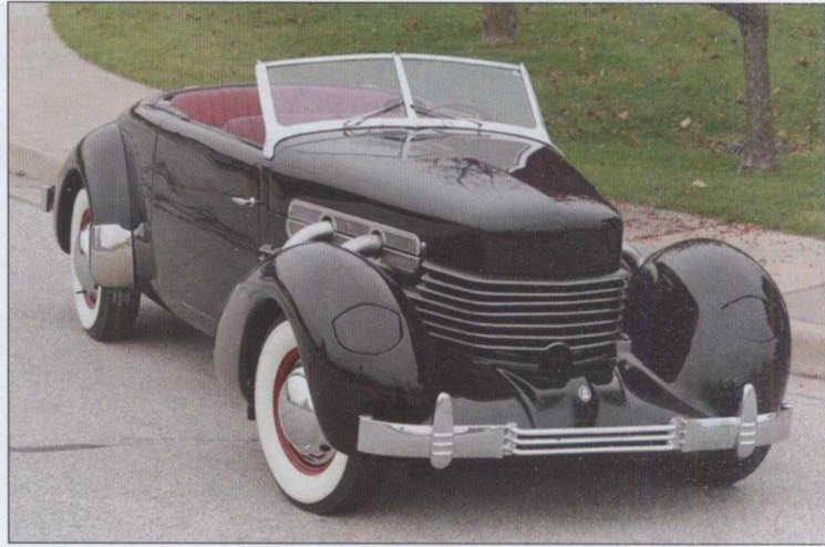
Корд-812 с кузовом фэтон и наддувным двигателем (по бокам капота видны трубы выпускного коллектора). Фары в убранном положении
