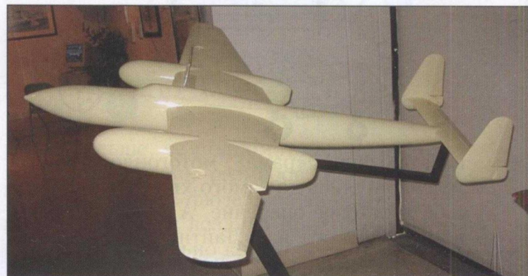
Первоначально проект истребителя D-2 Говарда Хьюза имел классическую компоновку с разнесенным оперением. Затем мотогондолы удлинени, превратив самолет в «раму»
